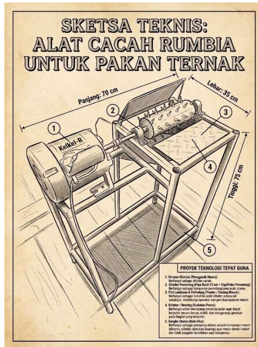
Gambar 2. Desain mesin cacah rumbia untuk pakan ternak
